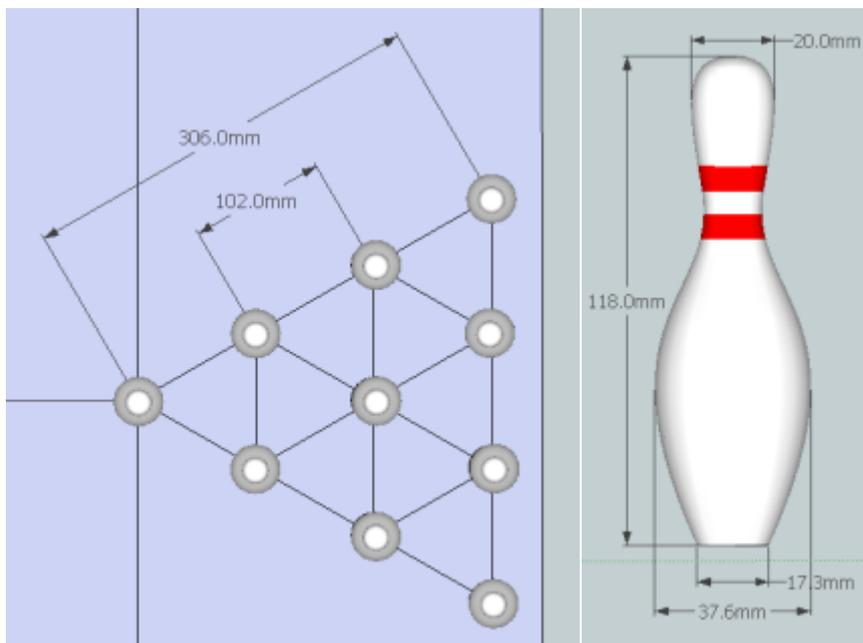
圖 5 木製保齡球瓶規格 (  $\pm 3$  mm )
