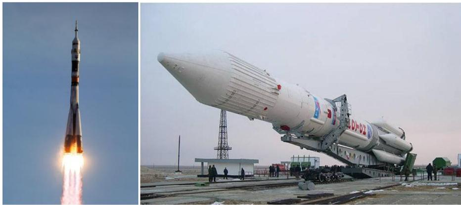
新型火箭能夠自行飛往在太空中的永久部署位置就位。從發射地點到最終的目的地都完全依靠火箭本身。但是在火箭前往太空之前，火箭組件必須先從工廠運送到發射位置。接著再將這些零件組裝在發射器上，將火箭抬升至垂直位置準備發射。發射前還必須確認所有人員均已疏散至安全區域。
