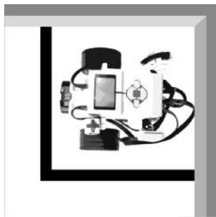
機器人正投影完全在起始/結束區內
